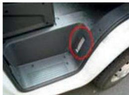
El número de chasis figura en elguardabarros de la rueda delantera derecha.
